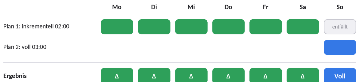
Abbildung 8: Parallele Zeitpläne: täglich inkrementell, sonntags voll. Sind beide fällig, läuft nur der Vollbackup.
