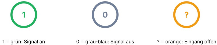
Abbildung 4: Signalfarben der Anschlüsse
